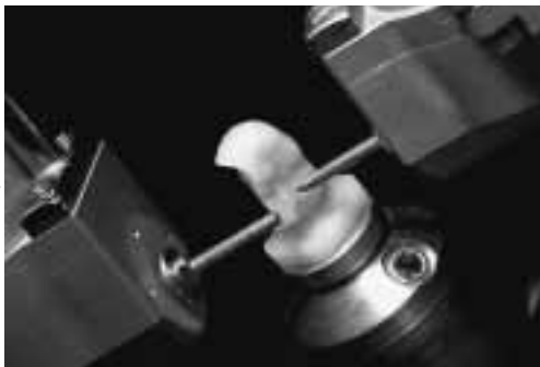
Schleifvorgang an einer Keramikkrone
